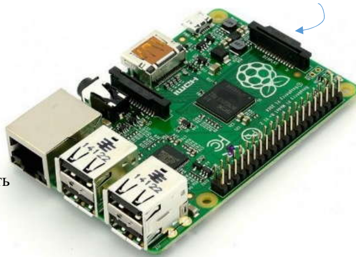
Порты, как на компьютере: ETH, USB, HDMI, MicroSD
